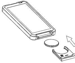
Ziehen Sie den Batteriehalter heraus und legen Sie eine neue Batterie ein (3V)
